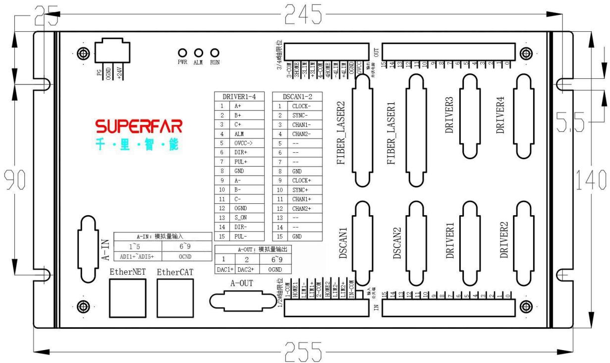
QLS-422 控制卡是千里智能自主研发的高端平台振镜联动卡,采用强大的 CPU 计算,主要用于有多轴运动的平台、振镜、激光的加工应用中,实现平台振镜联动,大大提高加工效率,如 3D 打印, PCB/FPC,指纹识别芯片,摄像头模组等激光精密切割,大幅 PCB 打标,晶圆打标等。
